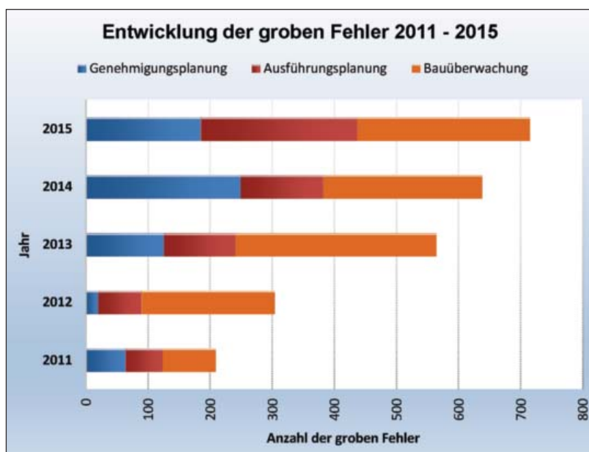
Abb. 1: Bei der Prüfung der bautechnischen Unterlagen und der Bauausführung von Ein- und Zweifamilienhäuser im Land Brandenburg festgestellte grobe Fehler (Kategorie D)
