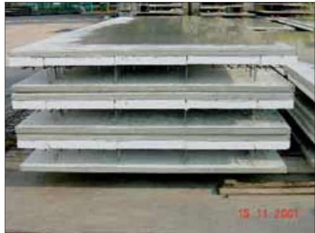
Abb. 3: Zulassungsgemäß hergestellte Thermo-Wände nach der Herstellung
