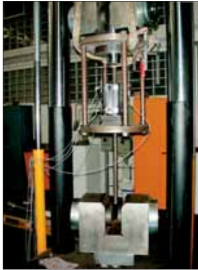
Abb. 12: Versuchseinrichtung zur Prüfung der Endverankerung
