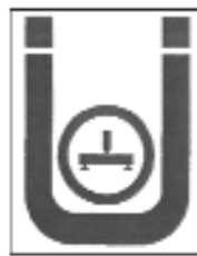
Abb. 1: Ü-Zeichen für ein nach Zulassung erstelltes Bauprodukt
