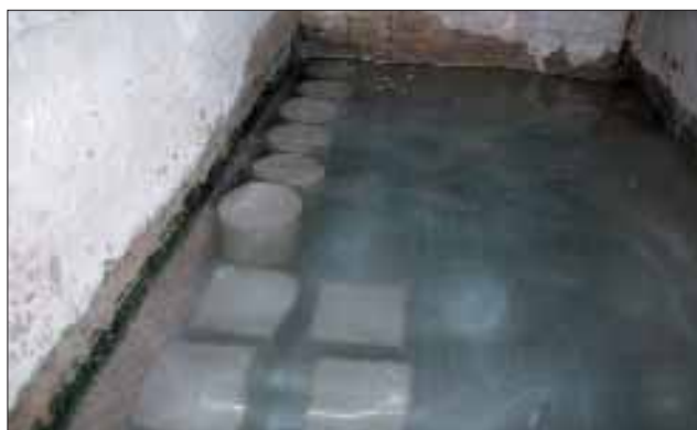
Abb. 4: In Wasser gelagerter Probekörper
