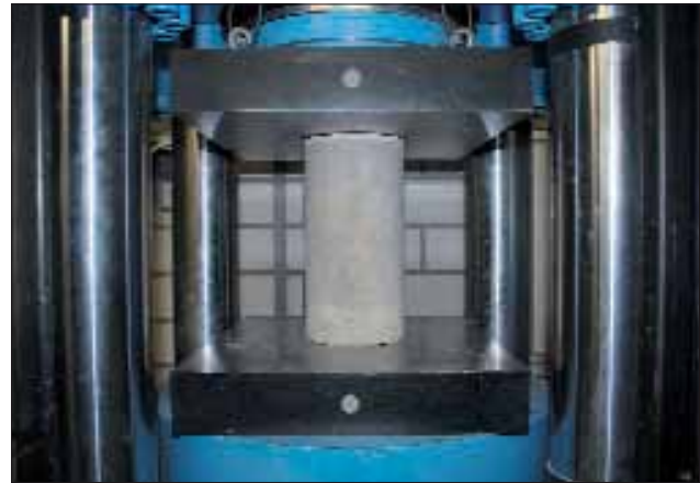
Abb. 2: Druckfestigkeitsprüfung an Betonzylindern
