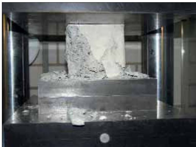
Abb. 3: Druckfestigkeitsprüfung am Betonwürfel
