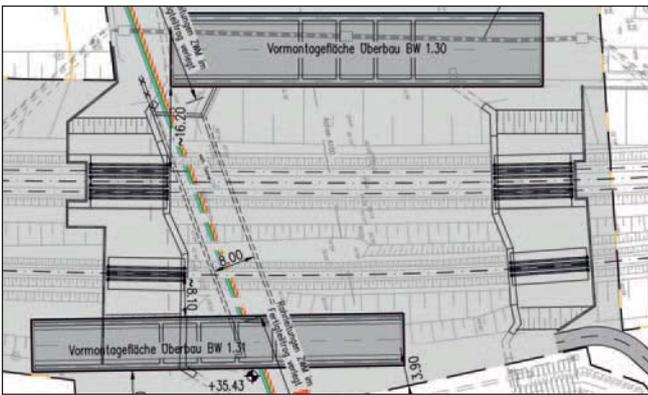
Abb. 10: Ursprünglich vorgesehene Lage der Vormontageflächen der beiden Stabbogenbrücken nördlich und südlich des Bahndamms
