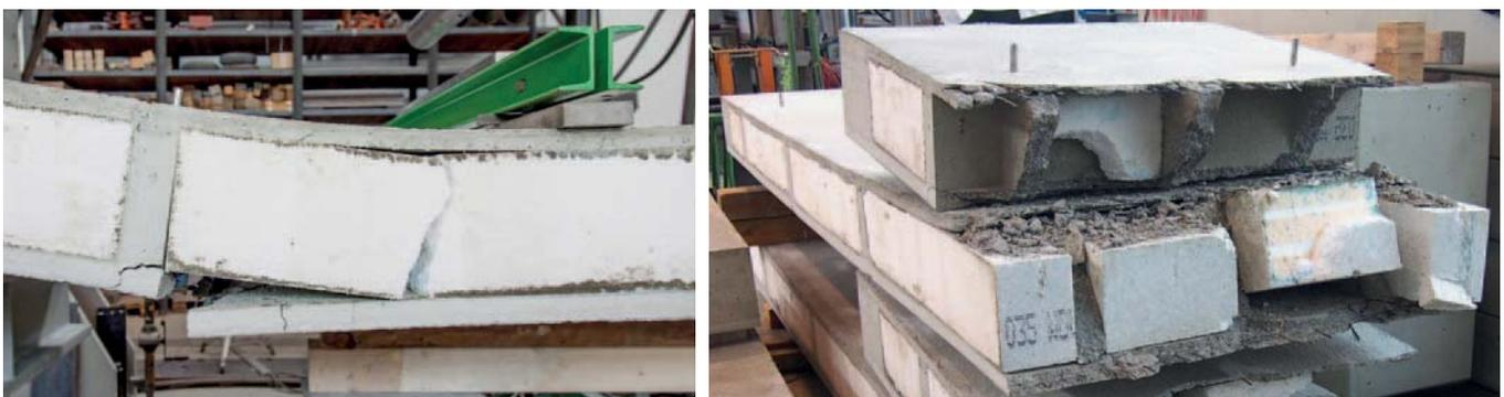
Abb. 6: Typisches Bruchbild infolge eines Querkraftversagens am Plattenstreifen Nr. 3
