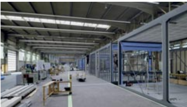
Abb. 6: Tragstrukturen von Stahlmodulen mit biegesteifen geschweißten Anschlüssen und temporären Diagonalen
