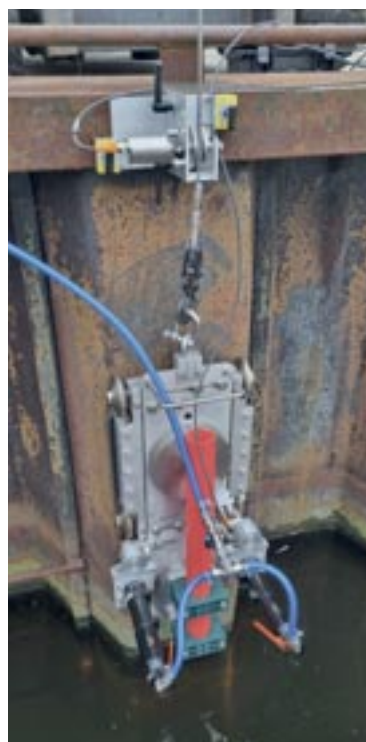
Abb. 8: Inklinometerwagen im Einsatz
