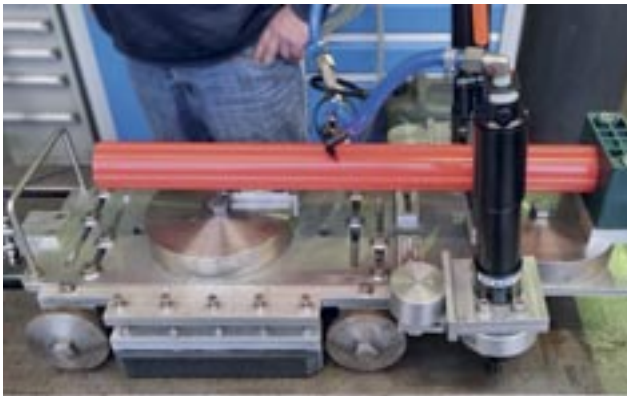
Abb. 6: Im Hamburger Hafen wird ein Inklinometerwagen eingesetzt, der Neigungen und Verschiebungen von Stahlspundwänden präzise erfasst und sie gleichzeitig gründlich reinigen kann.
