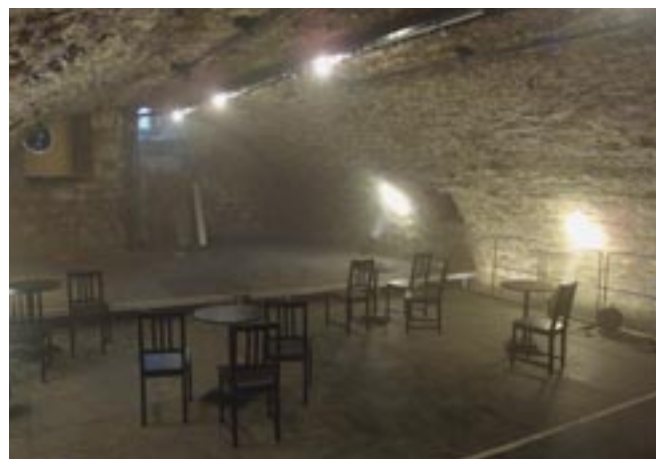
Abb. 9: Rauchversuch in einem historischen Kellergewölbe
