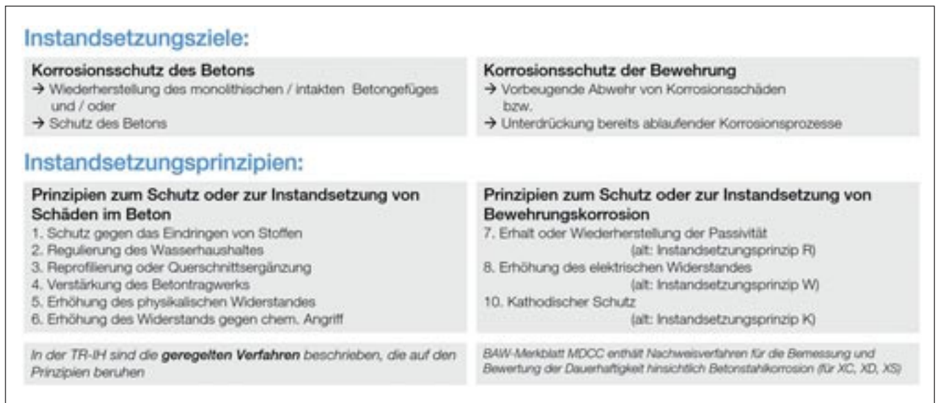
Abb. 6: Instandsetzungsziele und Instandsetzungsprinzipien
