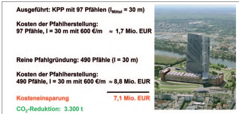
Abb. 14: Kostenvergleich der Pfahlherstellung und CO 2 -Reduktion bei der Europäischen Zentralbank
