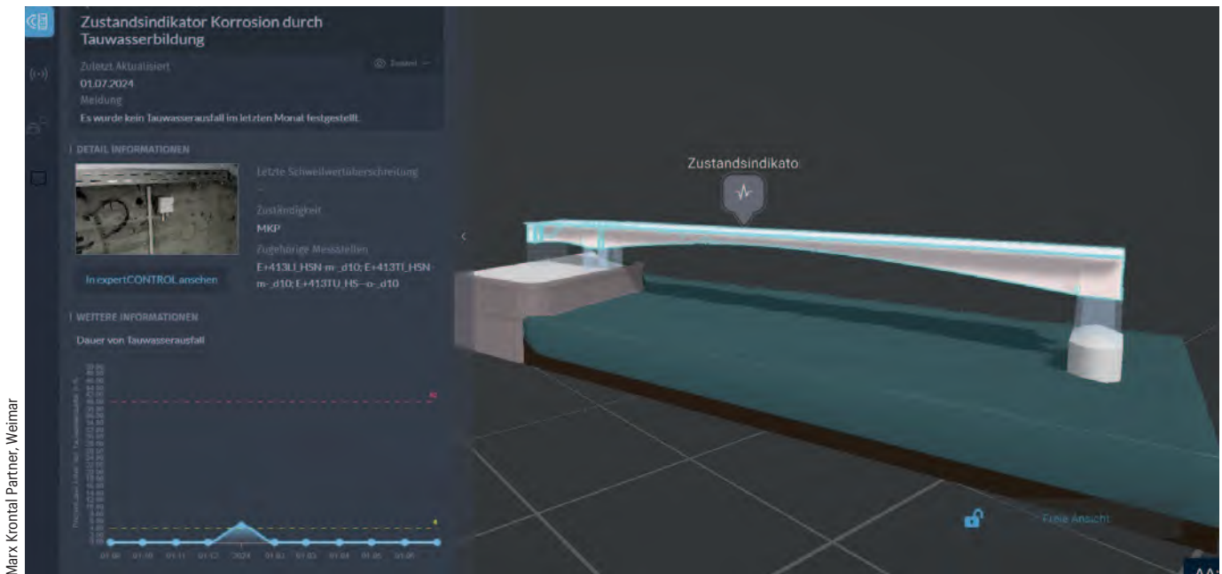
Abb. 10: Zustandsindikator Tauwasserbildung im Digitalen Zwilling eines Teilbereiches der Strombrücke
