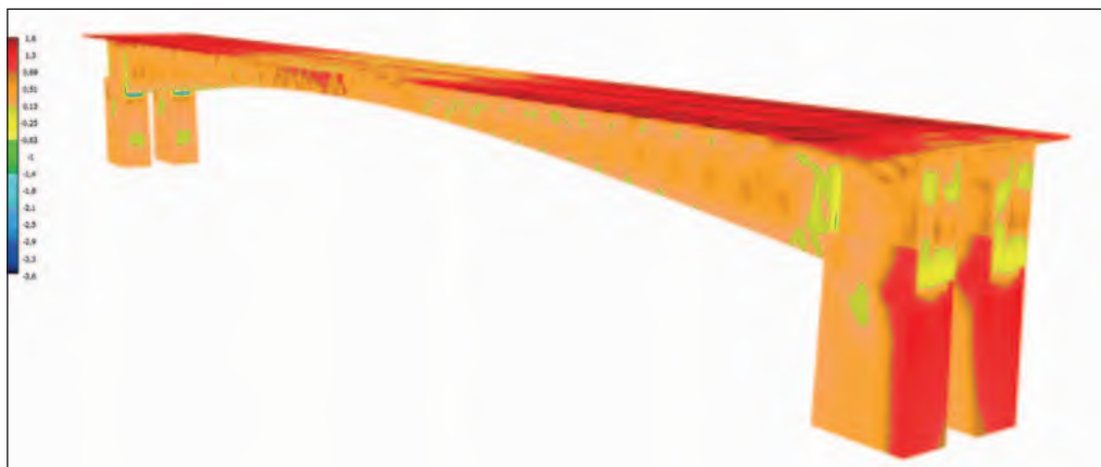
Abb. 21: Hauptspannungen \sigma_1 [N/mm 2 ] unter 1,0-facher Belastung
