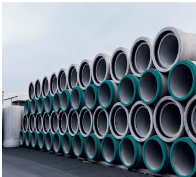
Abb. 3: Geopolymerbetonrohre für den Kanalbau dokumentieren den erstmaligen Einsatz eines zementfreien Bindemittels bei der Betonrohrherstellung. Statt Zement kommt ein Geopolymer als Bindemittel zum Einsatz. Vorteile sind: CO 2 -Reduktion in der Herstellung durch Zementersatz und eine höhere Widerstandsfähigkeit gegen chemische Angriffe.
